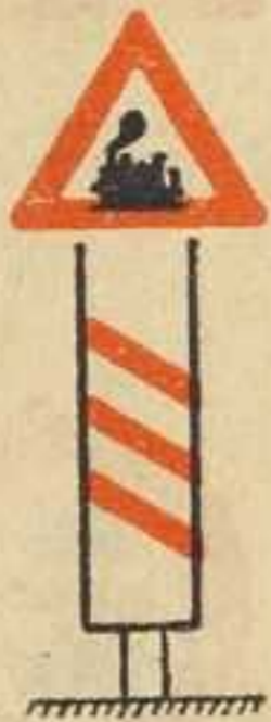
Návěstní deska - železniční přejezd bez závor.
