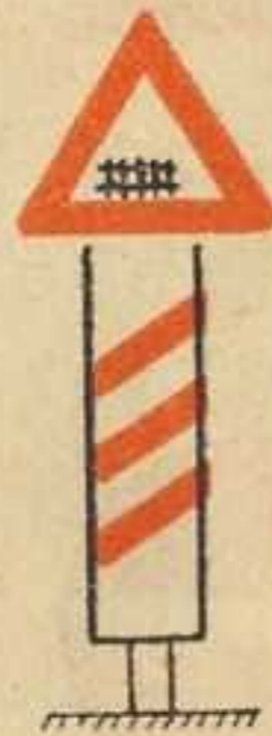
Návěstní deska - železniční přejezd se závorami.
