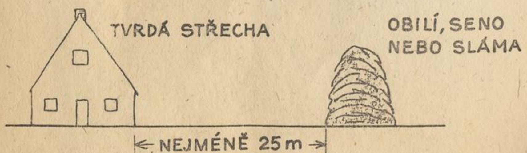
**Obraz 19.** Umístění stohů podle předpisů u budov s tvrdými střechami. Dbejte hlavního směru větru!
