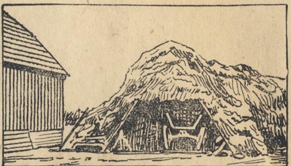
Obraz 36. Mezi hospodářskými budovami byl zřízen požárně nebezpečný kryt ze slámy pro povoz. Tímto »požárním mostem« se za požáru oheň přenese rychle z jedné budovy na druhou.
