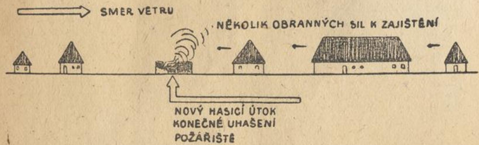
**Obraz 27.** Jakmile shoří lehká vznětlivá zásoby ve stodole, opadá hlavní síla ohně. Nyní se přejde z požární obrany opět k hasicímu útoku. Ve směru větru ležící a ohrožené budovy je třeba i nadále obsadit malým počtem svěpomocných sil. Bylo-li požářiště konečně uhašeno, je třeba nechat u něho požární hlídku, aby se mohlo ihned zabrániti opětnému vzplanutí ohně.
