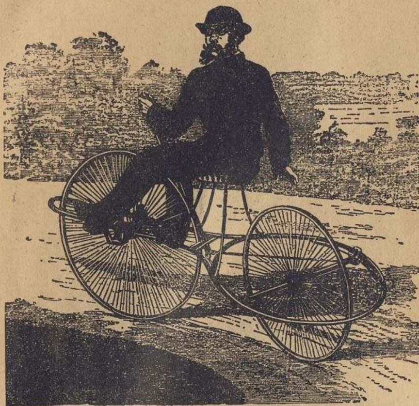
Kolo od Mc. Donalda, New York 1869. Nápadná jest konstrukce zadního kola v otáčivém rámu.
