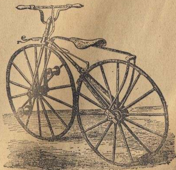
První brzda, ovládaná otočnou rukojetí na řídítku. Americký výtvar 1869.
